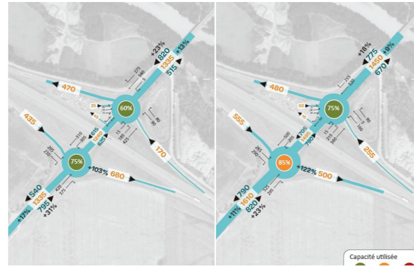
Mise en évidence des charges trafics futurs, variations de trafic et calcul des capacités utilisées futures des carrefours
