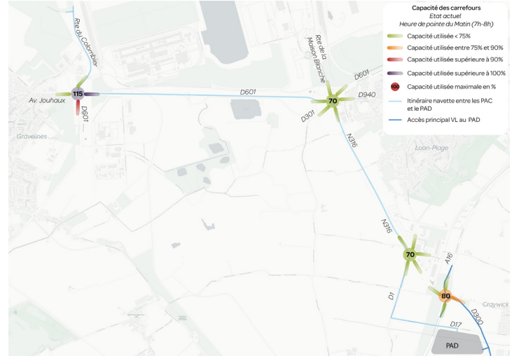
Comptages et calcul des capacités actuelles des carrefours d'accès à la centrale de Gravelines depuis l'A16 ▼
